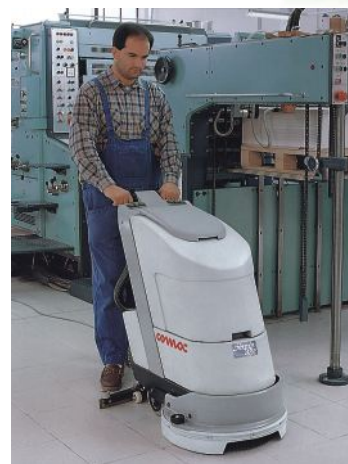
▲ K07-C50 電池式自走洗地機 K07-CE45 插電式自走洗地機 噴水、拋刷、吸乾一次完成
